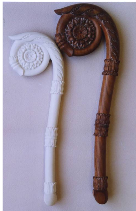
Modèle sculpté dans le bois après recherche typologique des anses à restituer. Modèle en bois et anse en porcelaine (retrait de 13%).
