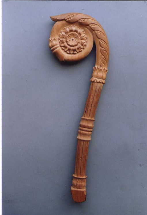
Modèle sculpté dans le bois après recherche typologique des anses à restituer. Modèle en bois et anse en porcelaine (retrait de 13%).
